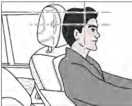
将头枕中心高度调节到与乘员耳朵上部平齐时，头枕才能发挥最大的保护作用。
