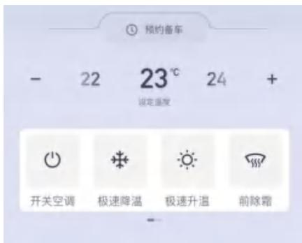
点击空调控制区，可进入空调控制二级页面，亦可点击极速升温、极速降温功能按钮实现快捷的车内温度调节。
