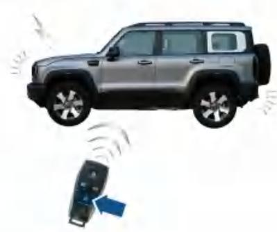
在已设防且未触发警报的状态下，按下解锁键后，所有车门同时解锁。此时转向灯闪烁2次。
