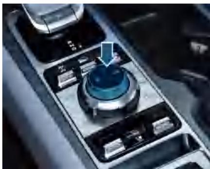
纯电优先：车辆优先使用动力电池提供的能量行驶，当动力电池电量消耗至一定值后，增程器进行能量补充，以维持合适的动力电池电量。
