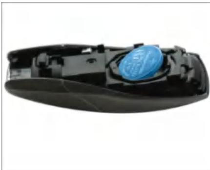
5. 安装电池时应避免接触电池表面并在安装前将电池擦拭干净；
