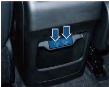
副仪表台后方配备USB和Type-C电源插座，能为移动设备充电。
