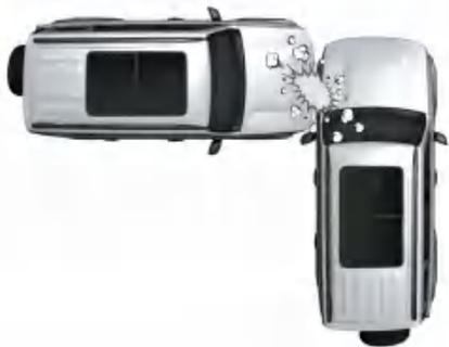
乘员车厢以外的侧面受到撞击时，车身受到微弱的碰撞，正向气囊、侧向气囊、侧向帘式气囊不工作。
