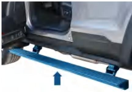
功能开启后，打开车辆的任一车门，该侧踏板将自动伸出；当该侧全部车门关闭，踏板将自动收回。
