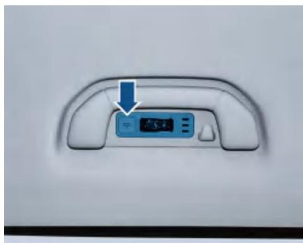
1. 按下后部照明灯开关，后部照明灯点亮。再次按下后部照明灯开关，后部照明灯熄灭。
