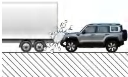
与大型货车发生追尾碰撞事故时，驾驶员本能地进行紧急制动，这时发生车体前部下沉。由于大型货车离地间隙较高，车辆前部会钻到货车底部，车辆前部的溃缩变形会吸收撞击能量，碰撞减速度未达到气囊展开条件，此时气囊可能不展开。
