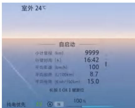
自启动界面显示本次启动小计里程、行驶时间、平均车速、平均油耗、平均电耗五种信息。
