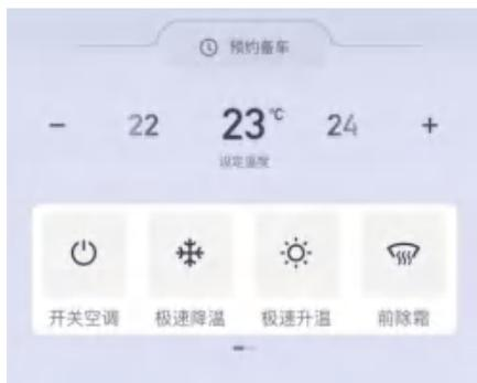
空调控制开/关、极速升温、极速降温、前除霜等快捷控制按钮。
