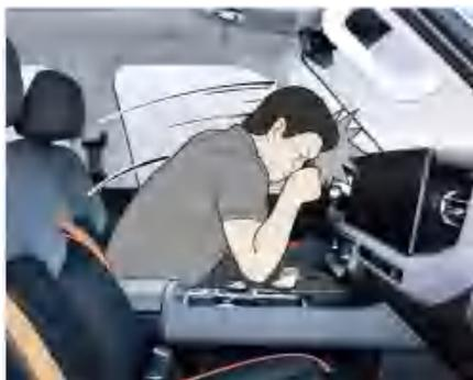
即使车速很低，在发生碰撞时作用在人体上的力也很大，乘员根本不能用手控制住自己的身体，未系安全带的乘员将被向前抛出，一旦撞击到车内的任何物件都有可能造成严重伤害。
