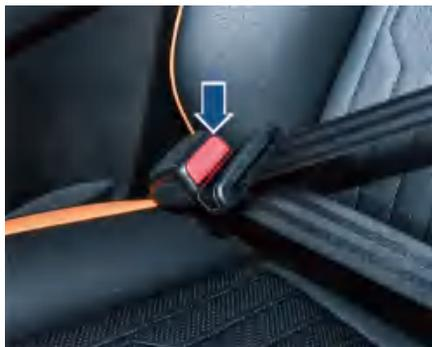
1. 按压安全带锁扣旁的红色按键，安全带锁舌将自动弹出。
