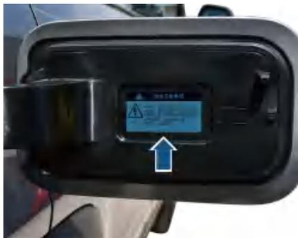
车辆充电警告标识位于车辆交/直流充电口护板内侧。
