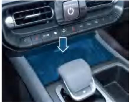
手机无线充电区域位于空调面板下方，可为已启用Qi®的智能手机充电。使用时，将智能手机放在充电器上手机防滑垫的限位筋内即可。
