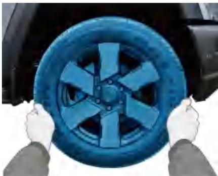
将备用车轮的安裝孔与刹车盘上的安裝孔对准。
