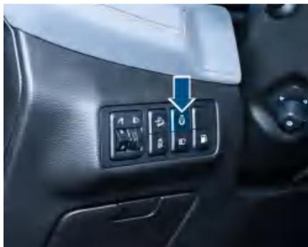
车辆处于“RUN”模式时，按下方向盘加热开关，方向盘加热工作指示灯亮，方向盘开始加热。再次按下即可关闭。
