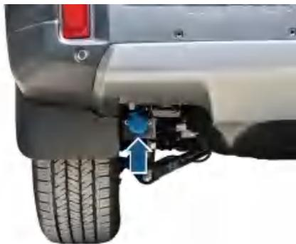
挂车取电口（连接器）位于车辆后拖车钩附近，打开取电口盖即可使用。
