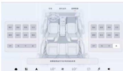
驾驶员座椅和副驾驶座椅都具有靠背按摩功能，在中控屏座椅调节界面可进行此操作。左右座椅均可实现8种模式及各自3挡强度的启动、停止及调节，可通过中控屏及语音进行控制。
