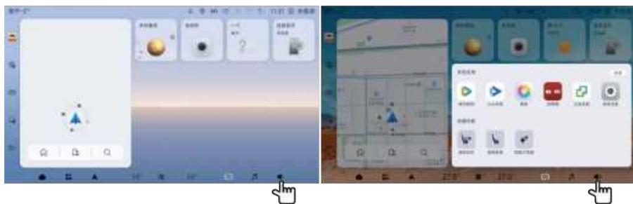
主屏界面：短按🔊音量图标可调节音量大小；长按🔊音量图标显示快捷功能界面。
