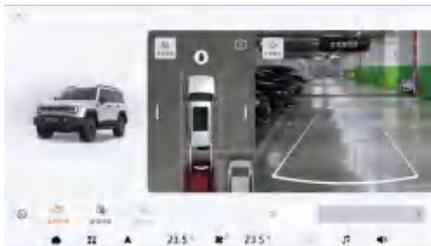
全景影像系统包含以下几个主要功能：控制器将布置于车身四周的4个摄像头的影像进行无缝拼接合成一幅360°全景图，显示效果类似于从空中俯拍的影像，能360°呈现车身周围的影像。
