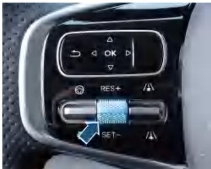
开启ACC后，向上拨动巡航功能RES+键，巡航车速以5km/h幅度进行增加，第一次向上拨动巡航功能RES+键，先将目标车速增加至最靠近5的倍数（比如43km/h会到45km/h）；向上长按巡航功能RES+键，目标车速以5km/h/s幅度进行增加。仪表实时显示更新的目标车速信息。
