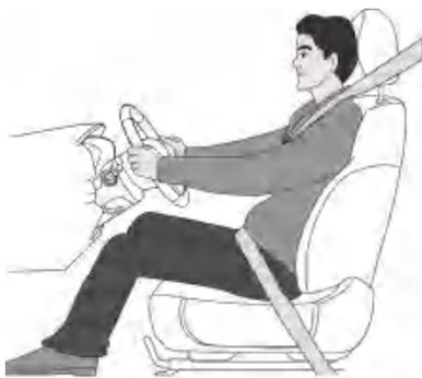
正确佩戴安全带可以将驾乘人员限定在合适的位置，免受伤害。正确佩戴安全带能够防止驾乘人员的失控运动，避免驾乘人员被抛出。
