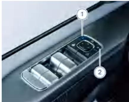
使用驾驶员侧车门饰板上的后视镜调节按键，可调节车外后视镜。
