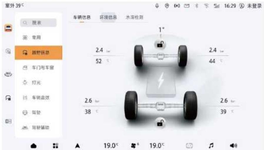
胎压监测系统，此界面为胎压监测界面，实时显示轮胎气压值、温度值信息，以确保行车安全。
