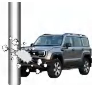
如果车辆与某些较细物体如电杆或树木等发生碰撞，在这种碰撞中，碰撞点集中在一处并且通过车辆严重变形迅速吸收撞击能量，没有把全部的碰撞力传递给气囊传感器，此时气囊可能不展开。车身受到微弱的碰撞，但是碰撞强度未达到气囊展开条件，气囊将不会展开。
