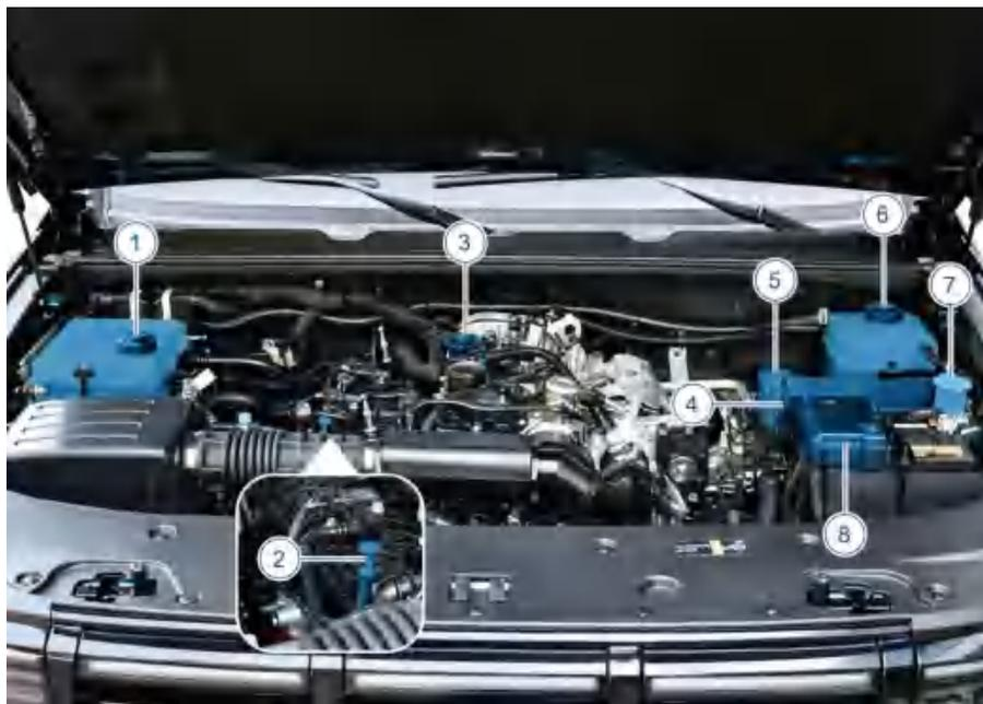
1. 电机及电池冷却液膨胀罐
