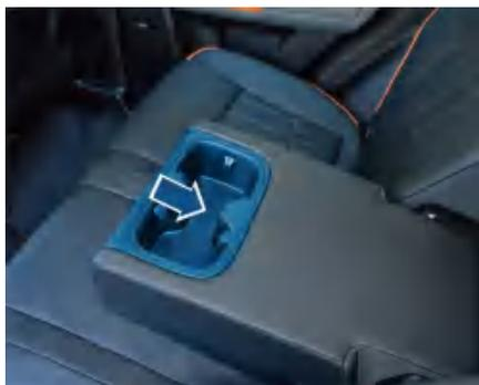
后排杯托位于后排中央扶手内侧。后排中央扶手开启时，可放置直径约66mm的饮料瓶或密封型茶杯。
