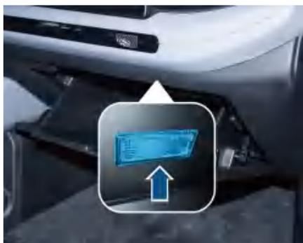
手套箱照明灯位于手套箱内部，在打开手套箱时，手套箱照明灯自动点亮，关闭手套箱后，该灯自动熄灭。
