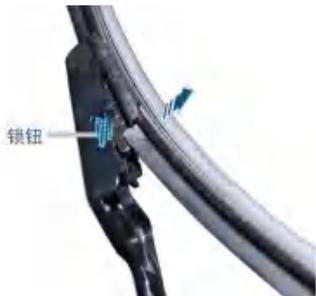
3. 按下锁钮使雨刮器片解锁，然后沿-箭头-方向取下雨刮器片。
