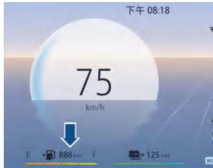
燃油表位于车速表下部，燃油表平均分成4段，启动/停止按键处于“RUN”模式时，燃油表显示燃油箱内剩余的燃油量，由“E”到“F”表示燃油箱由空到满。当启动/停止按键位于
