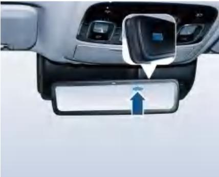
在夜间，自动防眩目内后视镜可根据后方光线的强弱自动调节内后视镜镜面的颜色深浅，以减少后方车辆灯光对驾驶员眼睛所造成的眩目。
