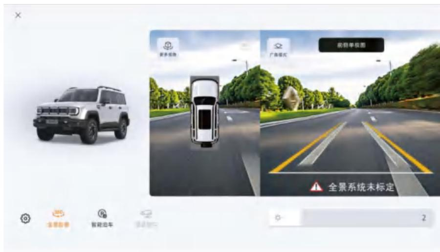
手动切换：主界面点击
