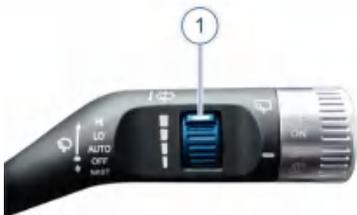
如图所示转动右侧多功能操纵杆间歇刮扫频率拨杆①，即可控制前风窗雨刮器间歇刮扫频率。向下转动降低频率，向上转动间歇刮扫频率则提高。
