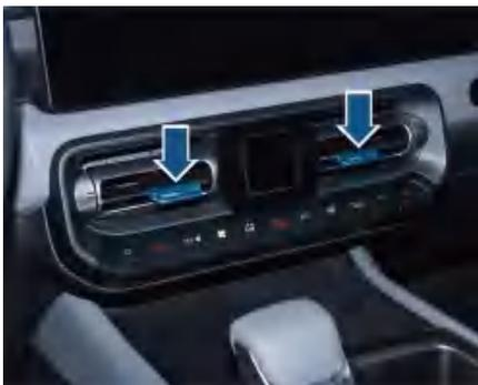
若欲调节各出风口气流的方向，只需向所需方向滑动出风口开关即可。
