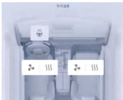
座椅通风/加热开/关，及挡位控制。
