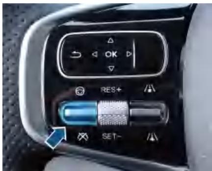
在集成式智能巡航开启状态，且系统满足激活条件，首先通过向上快速拨动两次巡航辅助开关激活IACC，此时若当前车速 $\geq 30\text{km/h}$ ，则将当前车速设置为目标车速；若当前车速 $\leq 30\text{km/h}$ ，则将 $30\text{km/h}$ 设置为目标车速。组合仪表中的蓝色ACC指示灯
