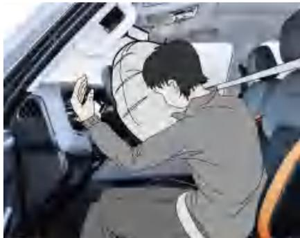
当车辆发生严重碰撞时，气囊系统会在人与车体之间迅速打开一个或多个充满气体的气垫，减轻驾乘人员受到的碰撞伤害。
