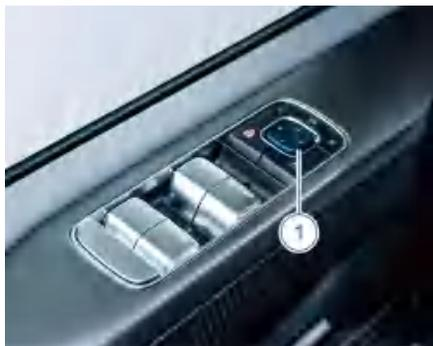
按下对应后视镜调节按键后，按压方向开关①调节车外后视镜角度。
