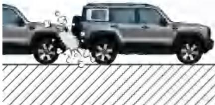
当发生后车追尾或碰撞时，在惯性力作用下，驾乘人员向靠背方向移动，从前面展开的气囊对驾乘人员也发挥不了任何保护作用，此时正向气囊可能不展开，侧向气囊、侧向帘式气囊不工作。
