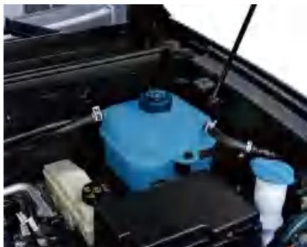
发动机处于冷态时，检查冷却液液位是否处在膨胀罐侧面标记范围内。
