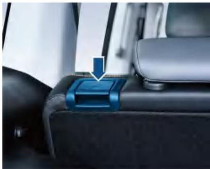
扳动座椅靠背解锁开关，调整到所需要的位置后，松开解锁开关。
