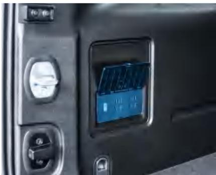
220V电源插座位于后备箱左侧位置，向上翻动电源插座盖板即可查看。车辆处于解锁状态且高压正常连接情况下，车内220V电源方可正常使用。
