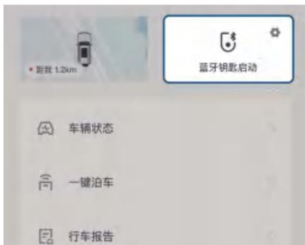
手机蓝牙钥匙可以取代智能钥匙，点触蓝牙钥匙对应按键，即可实现升降车窗、解闭车锁、解锁后备箱、寻车、蓝牙钥匙启动等功能。携带手机进入车内，并手动触发蓝牙钥匙启动功能，功能触发后2min内，踩住制动踏板并按启动/停止按键，即可启动车辆。功能触发2min后，需要重新触发蓝牙钥匙启动功能，方可进行车辆启动。
