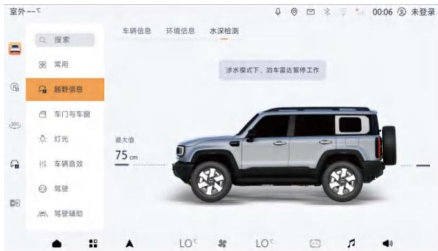
此界面显示水深检测界面，最大涉水深度：最深0.75m。当前涉水深度根据水深情况会有不同的报警方式。
