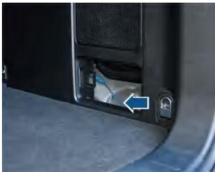
如果充电口电子锁止机构故障，应采用以下方式物理应急解锁：
