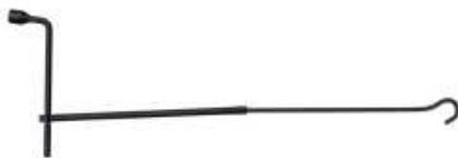
如图所示，先将千斤顶专用扳手、千斤顶专用扳手延长杆和车轮总成扳手，组装成如图所示的样子。
