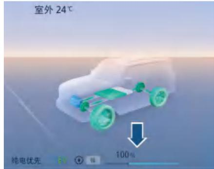
功率表指示范围 -100% ~ 100%。功率表用于指示驱动电机的瞬时功率百分比。如果指示在 0% ~ 100% 范围内，表示驱动电机正在输出功率；如果指示条显示绿色，表示动力电池进入能量回收状态。
