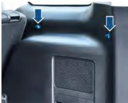
后备箱侧围内饰左右两侧各有2个挂钩，可以挂置物品，最大承重3kg。
