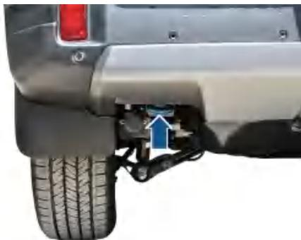
后部牵引环安装在车辆后部的焊接板上。
