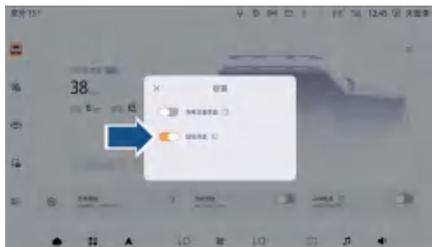
通过中控屏点击多功能按键
