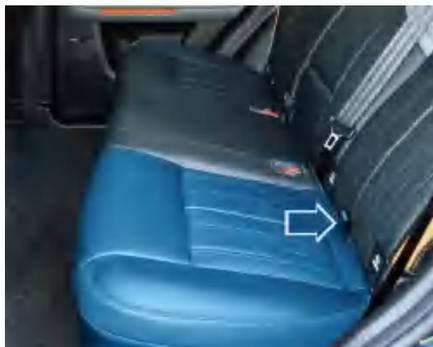
1. 用手拉动二排座垫拉带，向上拉起座垫后，向前翻转；
