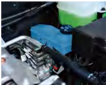
当发动机处于冷态时，检查制动液液位是否处在储液罐侧面标记范围内。
