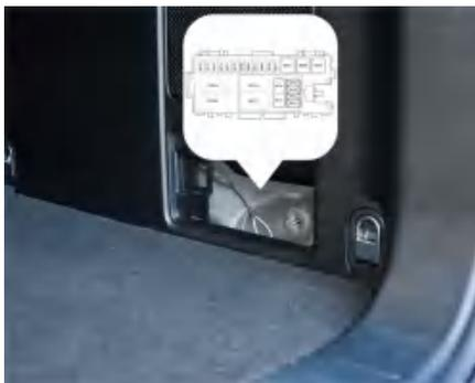
车身保险丝盒位于后备箱右侧，在维修口盖板后面，检查或维修时为便于查看需拆下维修口盖板。
