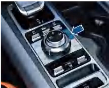
蠕行模式功能开启后，通过战术掉头开关可开启/关闭该功能，功能开启时，仪表会有相应指示灯进行指示。当车辆在进行转向，且该功能被打开，控制器会根据当前车速和驾驶员的转向请求，通过WCBS给内侧后轮施加制动压力，将其控制在设定滑移率范围内，以此减小转弯半径；该功能适用的车速范围为4km/h~10km/h。
