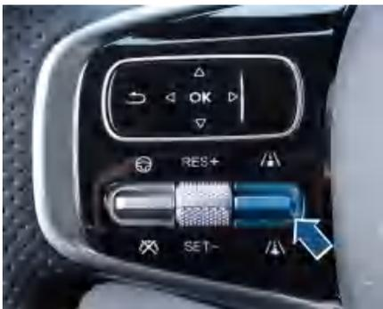
在ACC激活状态，向上拨动跟车距离调节键减小车间时距，向下拨动跟车距离调节键增加车间时距。车间时距设置有4个挡位。
