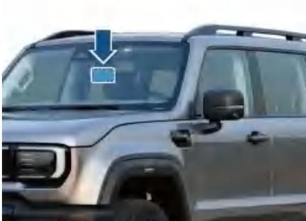
微波窗口用于安装车辆电子标识，其安装位置不允许贴膜、不允许有加热的金属丝、不允许有天线，不影响驾驶视野，保证数据的有效读取。微波窗口允许采用麻点的形式体现，黑区和麻点对电子标识接收信号没有影响。
