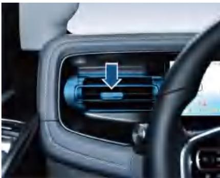
驾驶员侧出风口向左侧滑动可关闭出风口，向右侧滑动可打开发出风口。
