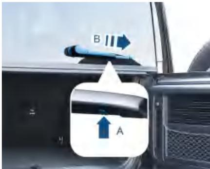
2. 按下-箭头A-锁钮使雨刮器片解锁，然后沿-箭头B-方向取下雨刮器片。
