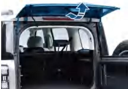
开启后风窗前，须先将尾门打开到最大位置，之后向上翻转，即可开启后风窗。关闭的操作与打开时相反。关闭后风窗时，尾门也必须打开到最大位置。
