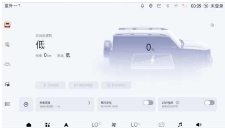
主界面点击
