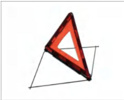
三角警示牌应根据国家的相关法规，安放在车辆行驶方向的后方。白天在普通公路上设置三角警示牌时，要把警示牌设在来车方向50m~100m左右的地方，如果在高速公路上，则要设置在来车方向最少150m的地方，夜间则还需依照实际情况增大距离。
