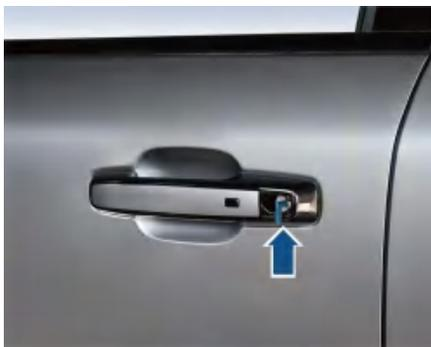
4. 车门锁芯逆时针旋转解锁，顺时针旋转闭锁。
