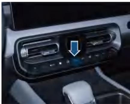
按下危险警告灯开关，危险警告灯开启，所有转向灯会同时闪烁，组合仪表中的两个转向信号指示灯也同时闪烁，再次按下危险警告灯关闭。
