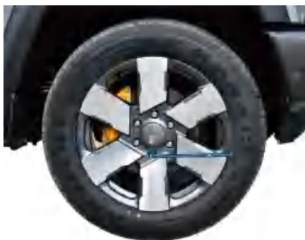
顶起车辆前，务必先拧松车轮上的各螺母。
