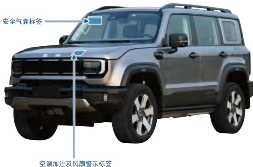
安全标签的位置如图所示，安全气囊标签贴于副驾驶侧遮阳板的关闭状态外侧，空调制冷剂、风扇叶片警示标签需打开前舱盖后才可见。
