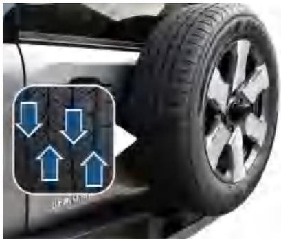
原装轮胎上均有磨损指示标记，磨损指示标记位于胎面花纹沟内的窄条中，分布在轮胎圆周上。在轮胎的胎侧有小三角指示出标记的位置。当胎面花纹磨损到指示标记时，应及时更换轮胎。
