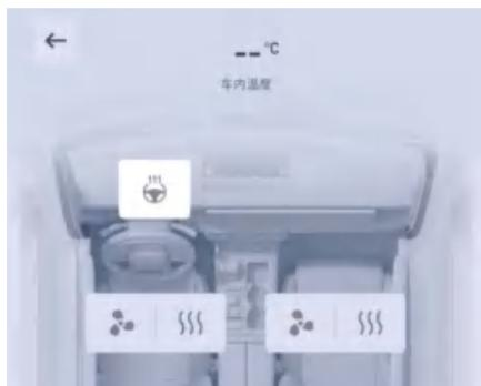
控制方向盘加热开/关。
