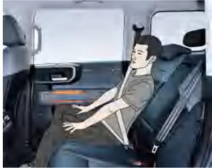
根据需要调节后排座椅头枕，在后排座椅上坐直并使后背尽量贴合座椅靠背。从位于就近一侧侧上方的收紧器中拉出安全带，将安全带的锁舌插入锁扣，系紧安全带，锁舌在锁扣中锁定时会发出咔哒声。
