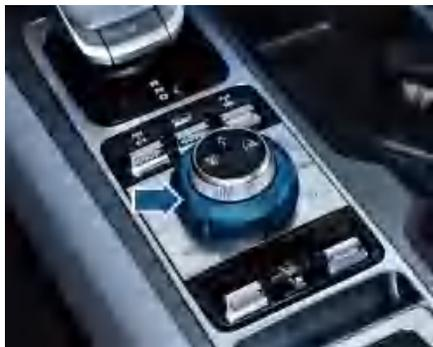
ATS系统包含了11种驾驶模式(运动模式、经济模式、舒适模式、雪地模式、穿越模式、沙地模式、泥地模式、岩石模式、涉水模式、单踏板模式、极速模式)。
