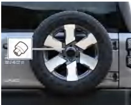
4. 将更换下的旧胎中心孔与备用车轮架上的螺柱对准，放置好。
