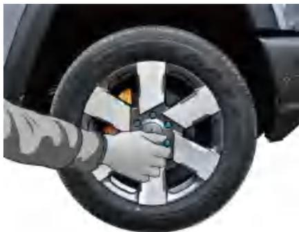
安装车轮螺母时，先用手尽量将车轮螺母拧紧。然后向后推一下车轮，看能否再拧紧一些。
