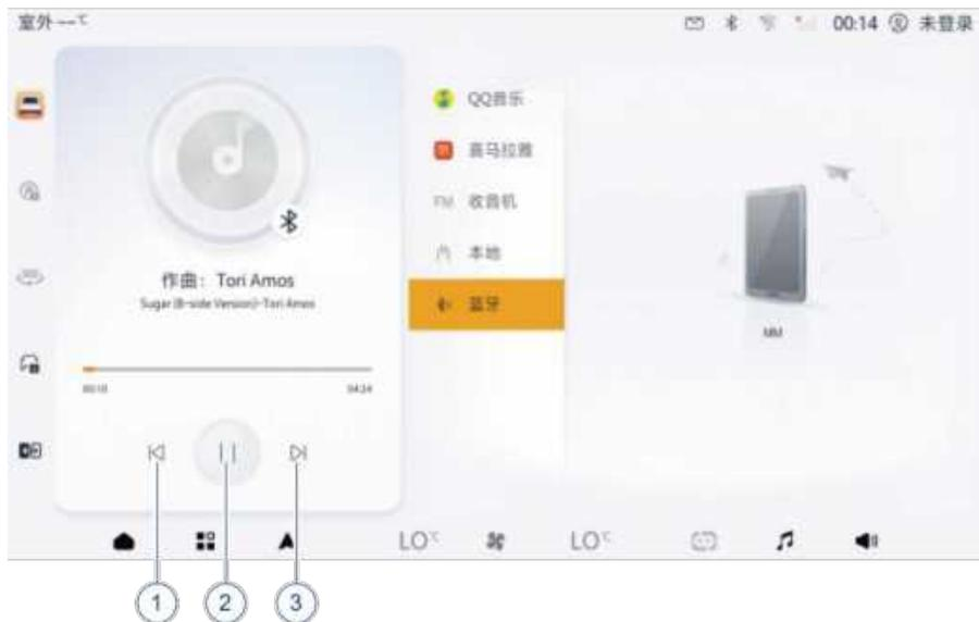
点击主界面上🎵多媒体图标，或主界面点击🗄️功能图标显示功能界面，点击【多媒体中心】图标，选择【蓝牙】，显示蓝牙音频播放源，通过屏幕上的按键控制音频播。
