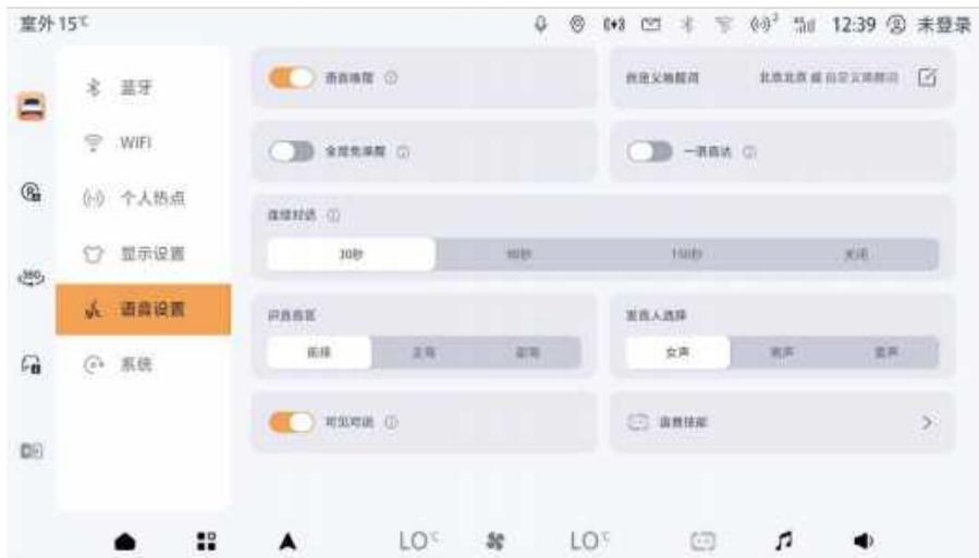
主界面点击
