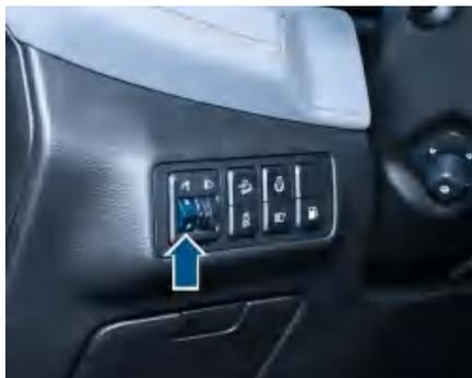
背光亮度调节滚轮处于驾驶员侧的仪表台开关组中。当车灯控制旋钮位于位置灯位置或近光灯位置时，整车各按键背光灯亮起。向上旋转调节滚轮，可增强背光，向下旋转则减弱。
