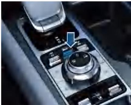
启动车辆后，推动蠕行模式开关，可开启蠕行模式功能。
