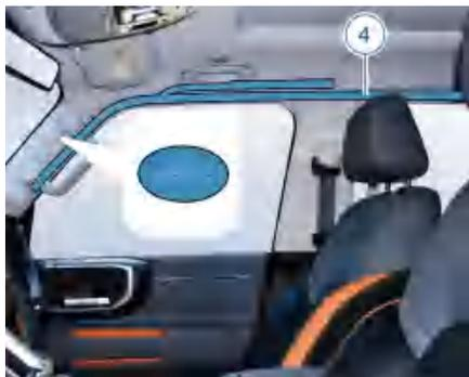
侧向帘式气囊④位于车顶两侧A柱、B柱与C柱之间沿车顶边缘的位置内，其标识盖上标有“**AIRBAG**”字样。
