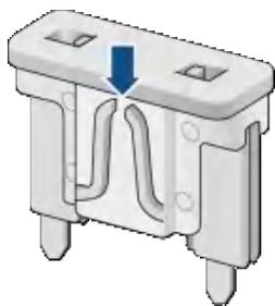
查找保险丝中已烧断的金属丝。如果已经烧断（图示箭头处的保险丝已出现连接断开现象），应使用安培值相同或较低的备用保险丝来更换。
