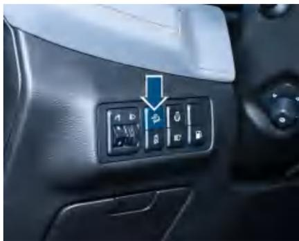
1. 按下HDC开关，开启陡坡缓降功能，此时仪表HDC灯点亮，表明HDC功能开启，处于待命状态；再次按下HDC开关可以关闭HDC功能；
