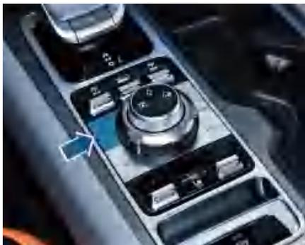
中控屏及副仪表开关按键中设有全景影像系统开关按钮，按下开关键可开启全景影像系统，在系统开启的情况下，再次按下开关键或通过中控屏点击全景影像界面中的退出按钮，可关闭全景影像系统。
