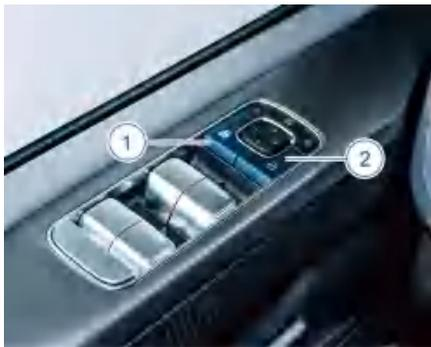
中央门锁按键位于驾驶员侧车门上。按动解锁按键①，中央门锁系统即解锁；按动闭锁按键②，中央门锁系统闭锁。
