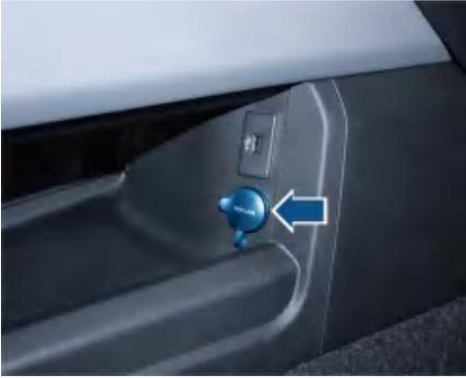
前排12V电源位于副驾驶侧左下方，翻开盖板，连接充电设备即可使用。
