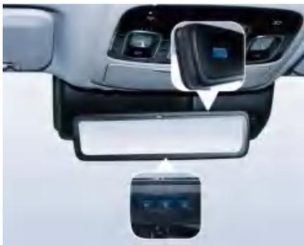
流媒体后视镜系统\*可根据前后方光线的强弱自动调节内后视镜面的颜色深度，以减少后方车辆灯光对眼睛所造成的眩晕。
