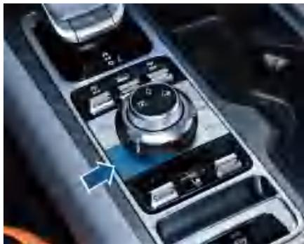
车辆启动时，驾驶员侧车门关闭，安全带系上，按下“自动驻车”开关，自动驻车功能开启，其开关指示灯亮起。
