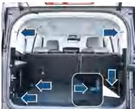
行李固定钩安装在后备箱内，用于固定松散的物品。使用时打开挂钩并使用网类或带类物品对行李进行固定。
