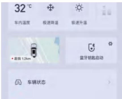
点击车辆位置查询区，可进入车辆位置查询二级页面。提供手机位置导航到车、车辆当前位置查看、电子围栏等功能。
