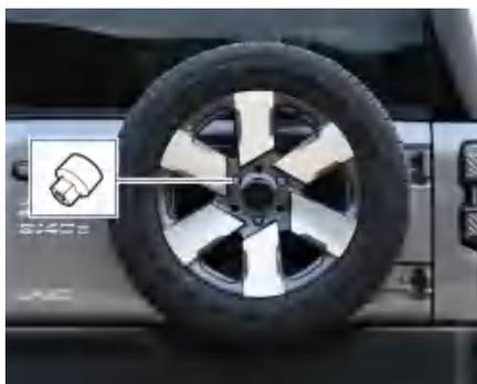
3. 将轮锁钥匙按照正确的角度插在轮锁螺母（如有）上，通过旋转轮锁钥匙将轮锁螺母取下；用车轮总成扳手逆时针方向拧松并取下其他备胎固定螺母（因车型配置不同，部分车型装配轮锁螺母及轮锁钥匙，具体请以实车为准）。
