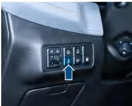
按下ESC关闭按键后，中控屏弹出ALL OFF、TCS OFF、VDC OFF、ALL OFF功能按键并组合仪表指示灯TCS OFF点亮指示灯，开启ALL OFF功能此时组合仪表指示灯
