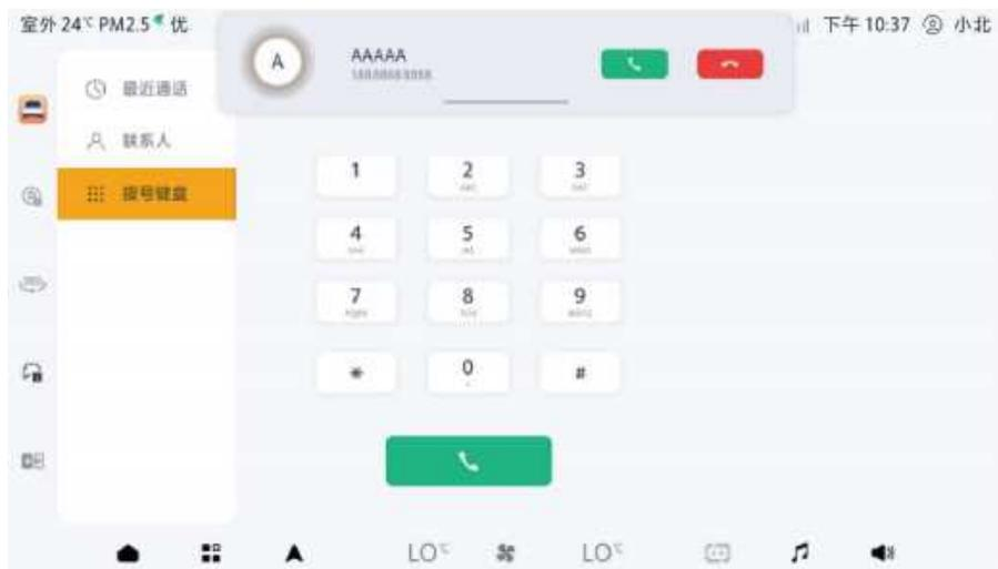
当手机与车机内置蓝牙建立电话功能连接之后，可通过手机或车机接听拨打电话。
