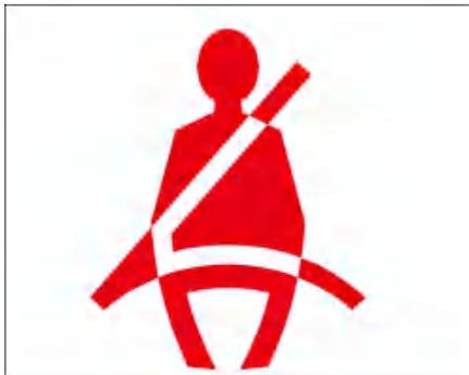
启动/停止按键在“RUN”模式时，驾驶员若未系安全带，仪表信息中心显示屏中的安全带未系警告灯就会亮起。行驶过程中若驾驶员未佩戴安全带，且车速超过25km/h，或在车速低于25km/h的情况下，行驶距离超过500m或时长超过60s时，该警告灯即点亮，并伴随警报音。
