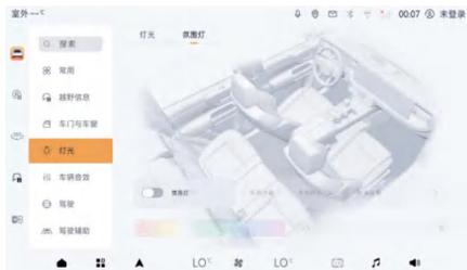
通过中控屏点击车辆设置 $\leftarrow$ 灯光 $\leftarrow$ 氛围灯，可开启/关闭氛围灯、选择氛围灯颜色\*，调节氛围灯亮度以及选择不同场景下氛围灯效果。您还可以在特殊提醒中打开/关闭开关门提醒、驾驶模式随动、空调设置提醒、涉水提醒等功能。
