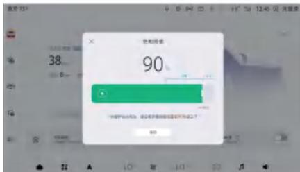
通过中控屏点击多功能按键
