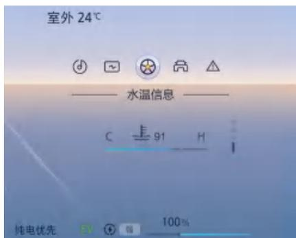
当启动/停止按键位于“RUN”模式时，发动机冷却液温度表显示冷却液温度。
