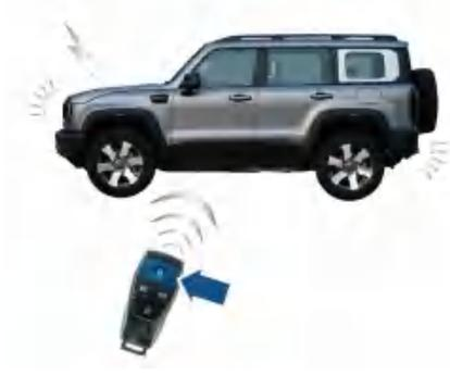
按下闭锁键，如果每个车门及尾门都已关闭，此时转向灯闪烁1次，同时车门和尾门闭锁，表示系统已进入防盗警戒状态。在该状态下，防盗系统会监控各车门、尾门、启动/停止按键状态。若此时再次按下闭锁键，则转向灯闪烁一次，系统再执行一次闭锁动作。
