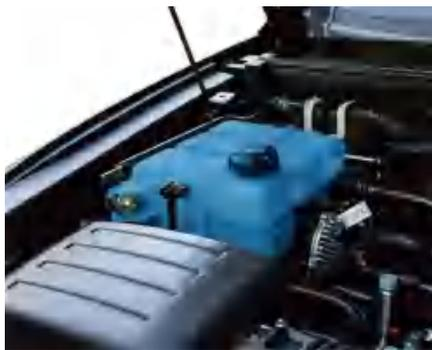
电机及电池停止工作时，检查冷却液液位是否处在膨胀罐侧面标记范围内。
