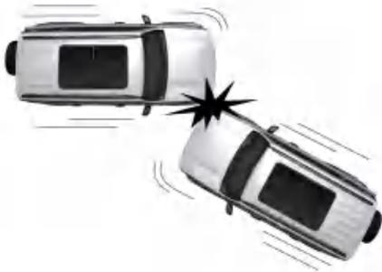
发生斜向碰撞时，气囊系统接收到的冲击能量可能不足以触发正向气囊展开，此时正向气囊可能不展开，侧向气囊、侧向帘式气囊不工作。
