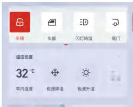
在车辆控制区内，可通过点击车锁等功能按钮，实现车辆解锁/闭锁、车窗升/降、寻车（闪灯、闪灯+鸣笛）等功能。
