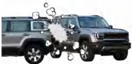
发生侧面碰撞时，驾乘人员产生侧向位移，所以从前面展开的气囊起不到对驾乘人员的保护作用，此时正向气囊可能不展开，侧向气囊、侧向帘式气囊可能展开。
