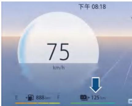
动力电池电量表用于指示动力电池的剩余电量，动力电池电量过低时指示灯显示黄色。
