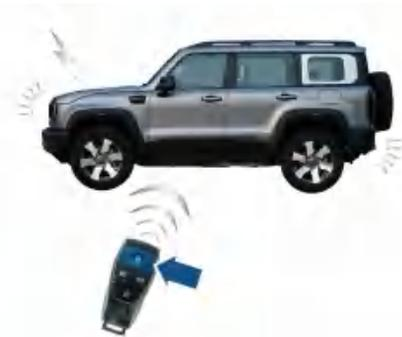
智能钥匙处于车外，启动/停止按键位于“OFF”模式，前舱盖、四门及尾门都已关闭，按下闭锁键，锁止车门，车辆鸣笛、转向灯闪烁。
