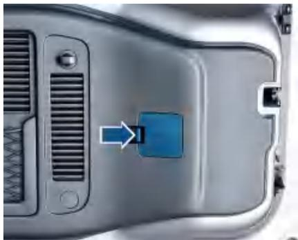
1. 进入车内，撬下位于尾门内侧的应急盖板。
