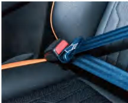
正确调整前排座椅及其头枕，从收紧器中拉出安全带，将安全带的锁舌插入锁扣，系紧安全带，锁舌在锁扣中锁定时会发出咔哒声。
