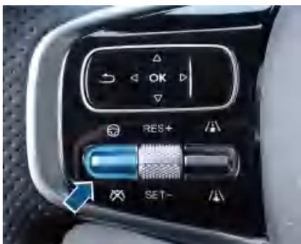
在ACC激活状态，向下拨动ACC开关，会取消ACC，此时ACC未完全关闭，向上拨动ACC开关，向上拨动RES+，或向下拨动SET-按键可以重新激活。
