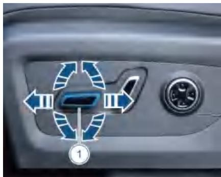
拨动开关①，根据图中箭头方向，可以随意调整座椅的高低、座垫角度/副驾腿托\*或座椅前后移动。
