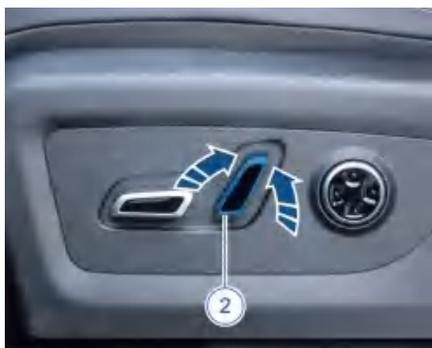
前后拨动开关②，根据图中箭头方向，可以调整座椅靠背的角度。
