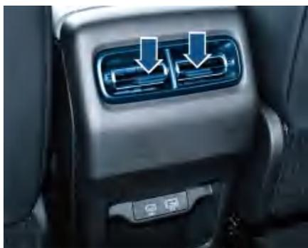
欲调节出风口气流方向，只需向所需方向滑动出风口开关即可。
