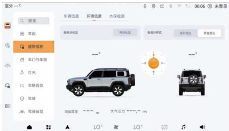
此界面显示：车辆倾斜角、车辆俯仰角、海拔高度、大气压力、指南针信息、指南针样式切换、指南针标定。
