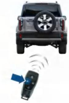
短按智能钥匙灯光按键，打开位置灯和近光灯，60s后自动熄灭；位置灯和近光灯开启时，再次短按灯光按键，位置灯和近光灯熄灭。
