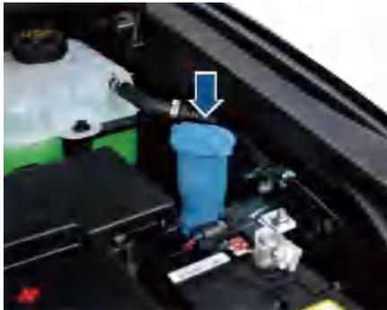
前、后风窗清洗器均由前舱内的清洗液储液罐提供清洗液。若发现清洗液液位过低，应当及时向储液罐中添加清洗液。
