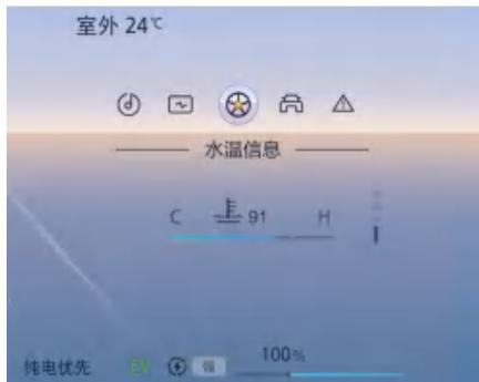
启动/停止按键在“RUN”模式时，冷却液温度表显示发动机冷却液温度。正常行驶条件下仪表刻度应位于中间位置大约90°C位置。发动机高负荷运转且环境温度很高时，冷却液温度会升高，对应的刻度指示也会增加。当冷却液温度过高，温度表光带向右侧延伸、发动机冷却液警报灯点亮时，表示车辆存在故障。此时应立即在安全处停车，关闭发动机，并待冷却液冷却后，检查冷却液液位。
