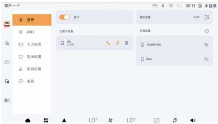
配对连接好蓝牙设备后，蓝牙设置显示已配对好的蓝牙手机设备型号，可点击
